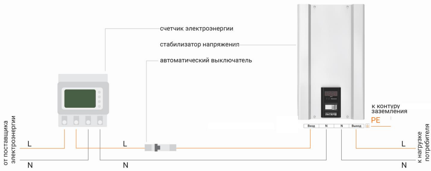
Рисунок 6. Схема подключения стабилизатора к однофазной сети
