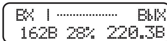
Высвечивается после двойного нажатия на кнопку «Вправо». Графический индикатор процента загрузки - показывает долю от максимально возможной при данном входном напряжении выходной мощности.
