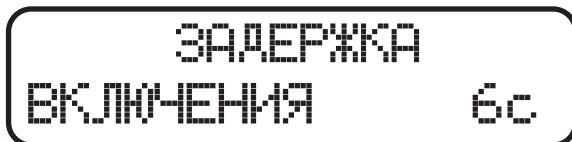
Показывает, через сколько секунд после запуска (включения входного автомата) стабилизатор подаст напряжение на выход.
