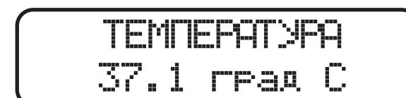
Температура основных элементов прибора, в градусах Цельсия (°C). Максимальная температура может составлять не более 80 градусов, в противном случае устройство отключится.
